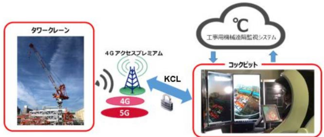
圖 2、塔式起重機遠端控制系統概要 [2]
