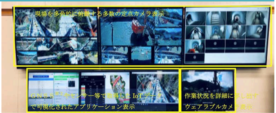
圖 1、使用監視器進行現場管理 [2]
