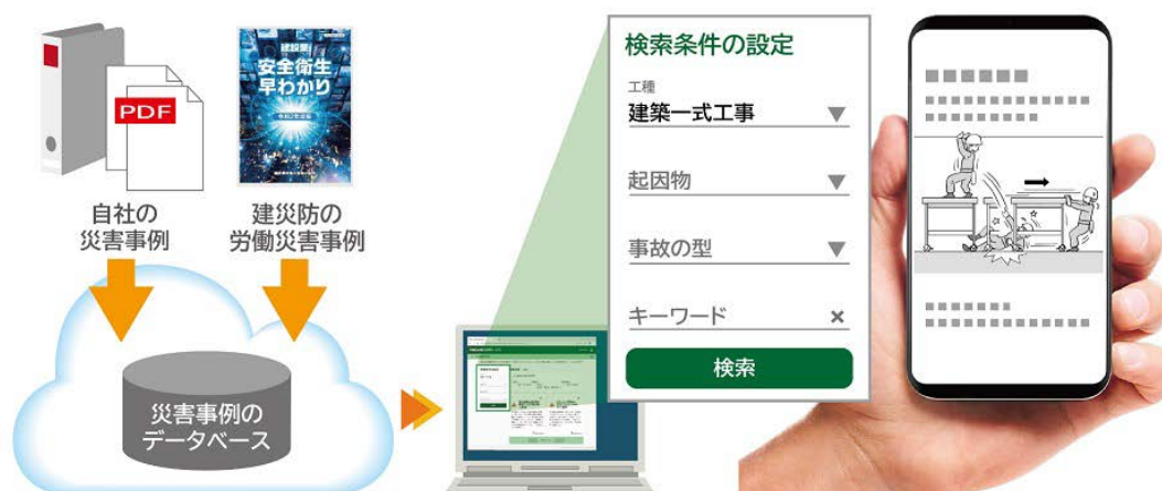
圖 2. 營造安全知識檢索系統架構 (建災防, 2021)
