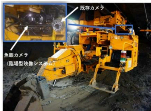
図2 本システム設置掘削機
